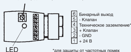
Потенциометр для настройки точки переключения
