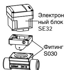
Компактный расходомер типа 8032 состоит из электронного модуля типа SE32, смонтированного на фитинге типа S030 со встроенной крыльчаткой. Электроподключение осуществляется в зависимости от исполнения - при помощи разъема по EN 175301-803 и/или мультиполюсного разъема M12.
