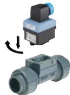
Расходомер типа 8032 монтируется на трубопроводе вместе с фитингом Bürkert типа S030. Соблюдайте минимальные расстояния на входе и выходе. Для достижения максимальной точности участка стабилизации потока можно удлинить. Более подробную информацию см. в стандарте EN ISO 5167-1.
