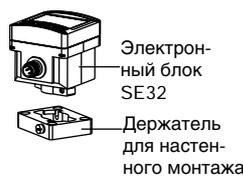
Расходомер типа 8032 для настенного монтажа - это электронный модуль типа SE32, закрепленный на стене при помощи специального держателя. Электроподключение осуществляется при помощи двух мультиполюсных разъемов M12.
