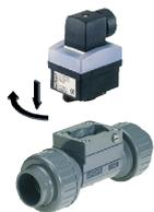
Расходомер типа 8030 монтируется на трубопроводе вместе с фитингом Bürkert типа S030. Соблюдайте минимальные расстояния на входе и выходе. Для достижения максимальной точности участки стабилизации потока можно удлинить. Более подробную информацию см. в стандарте EN ISO 5167-1.
