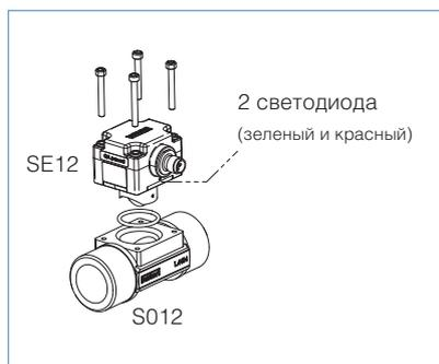
Расходомер типа 8012 состоит из электронного модуля SE12 со встроенной крыльчаткой, которая монтируется на фитинге типа S012.
